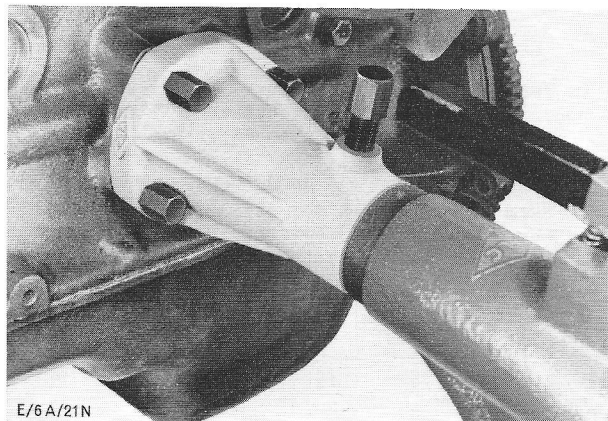
Afb. 26. Motor met behulp van steun 21-031 op montage standaard bevestigen
