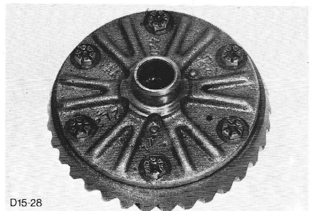
Fig. 90 Bevestiging van het kroonwiel op het satellietenhuis.
