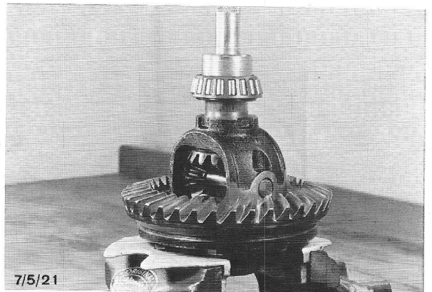
Fig.99 Pers met montagestempel 15-031 het conische rollager op het satellietenhuis.
