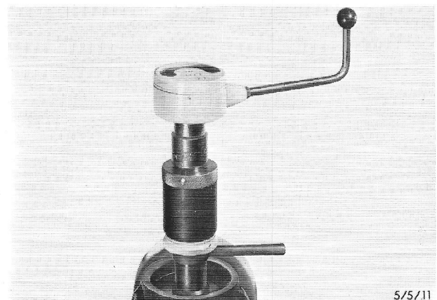
Fig.36 Draaiend koppel (voorspanning) van pignion meten.
